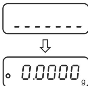
**i** Bei einem Justierfehler (z. B. Gegenstände befinden sich auf der Wägeplatte) erscheint im Display die Fehlermeldung <CAL NO>, Justiervorgang wiederholen.
