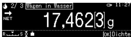
Abb.2: Wägung in Prüfflüssigkeit
