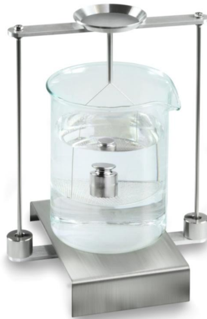
Abb.2: „Wägung in Prüfflüssigkeit“
