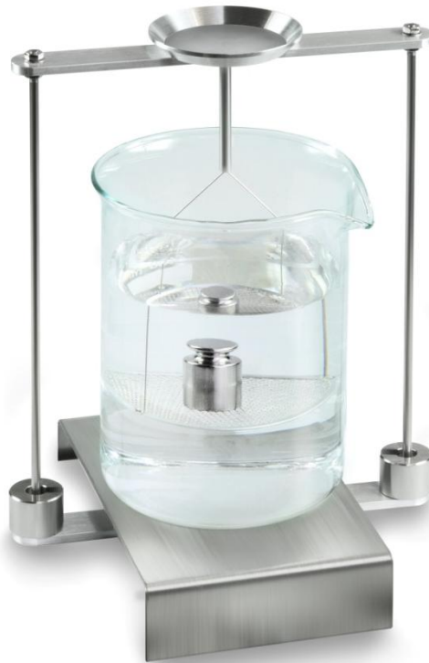
Abb.2: Wägung in Hilfsflüssigkeit
