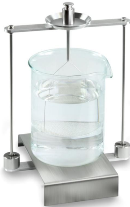
Abb.1: „Wägung in Luft“
