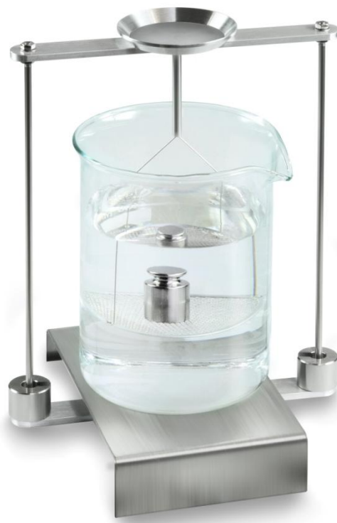
Abb.2: Wägung in Prüfflüssigkeit
