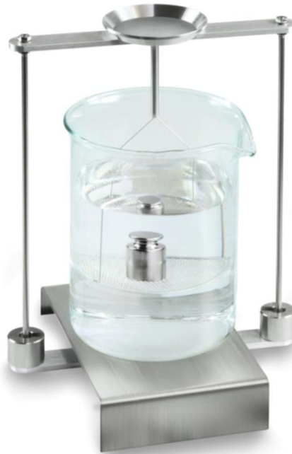
Abb.2: „Wägung in Hilfsflüssigkeit“
