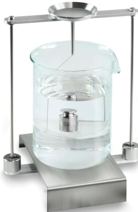
Abb.2: Wägung in Hilfsflüssigkeit
