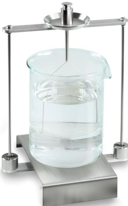
Abb.5: Wägung in Luft
