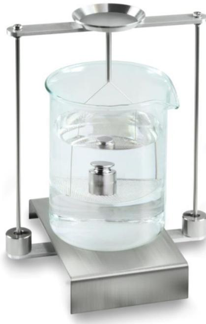
Abb.2: „Wägung in Prüfflüssigkeit“
