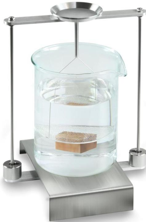
Abb.4: Wägung in Hilfsflüssigkeit
