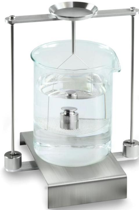
Abb.2: Wägung in Hilfsflüssigkeit
