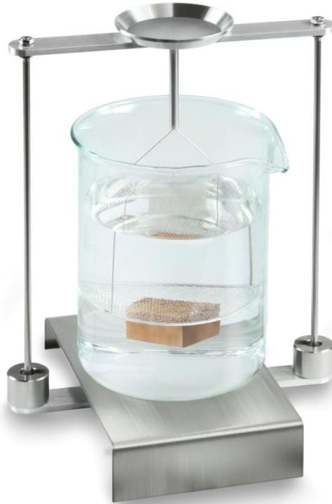
Abb.4: Wägung in Hilfsflüssigkeit
