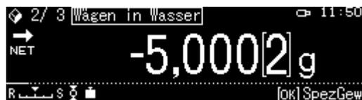
6. Stabilitätsanzeige (➔) abwarten, dann den Wägewert mit der OK-Taste übernehmen. Die Waage ermittelt die Dichte des Feststoffes unter Berücksichtigung des Luftauftriebs und zeigt diese an..
