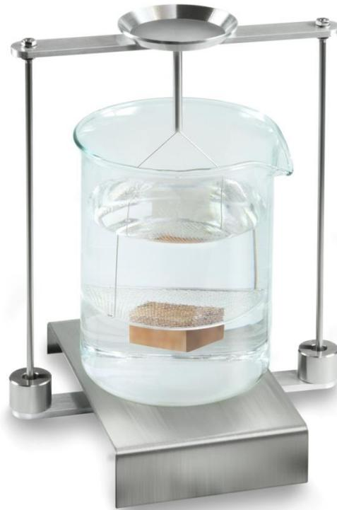
Abb.4: Wägung in Hilfsflüssigkeit
