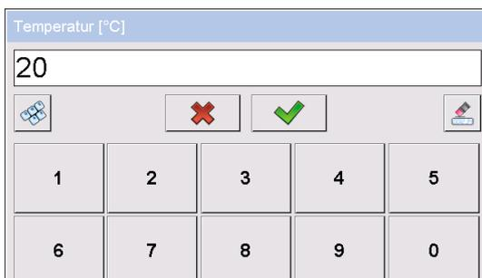
Bei Auswahl **<Wasser>** oder **<Ethanol>** als Hilfsflüssigkeit erfolgt hier die Eingabe deren Temperatur
