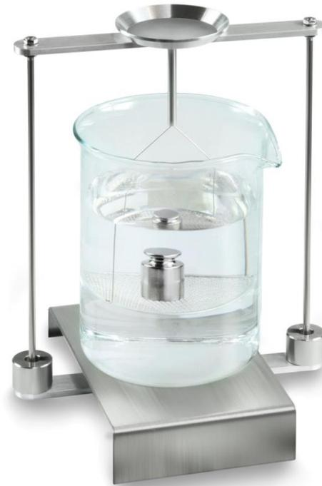
Abb.6: Wägung in Prüfflüssigkeit
