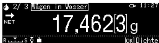
7. Stabilitätsanzeige abwarten, dann den Wägewert mit der OK-Taste übernehmen. Die Waage ermittelt die Dichte der Flüssigkeit unter Berücksichtigung des Luftauftriebs und zeigt diese an.
