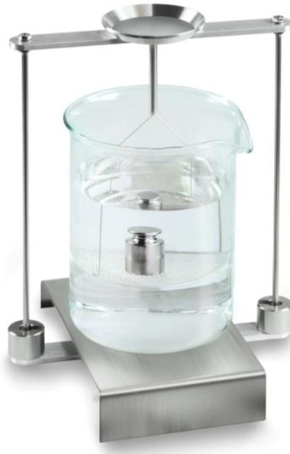
Abb.2: „Wägung in Hilfsflüssigkeit“
