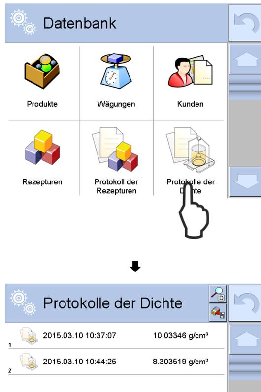
Zum **<Öffnen / Drucken>** Finger auf dem gewünschten Datensatz gedrückt halten, bis das Kontextmenü angezeigt wird.
