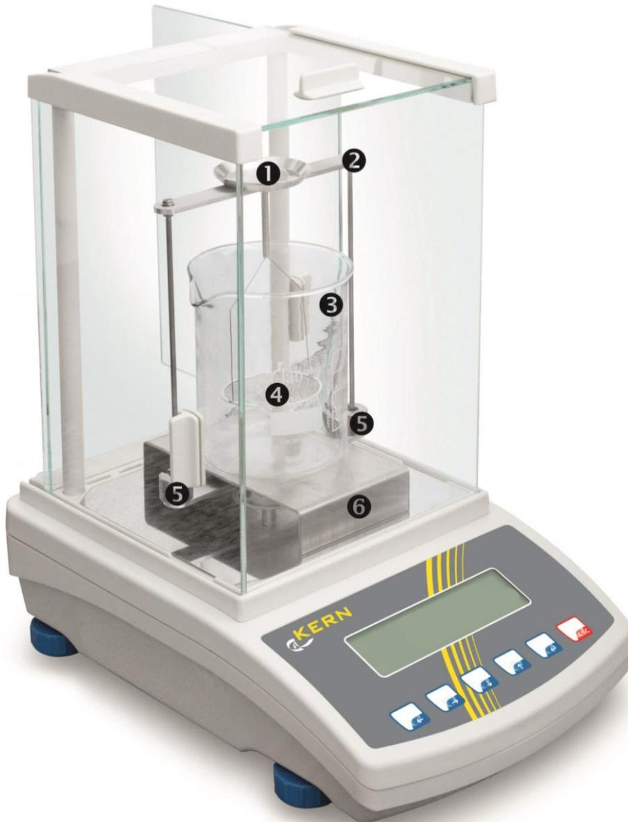
Abbildungsbeispiel mit installiertem Dichtesets KERN YDB-03
