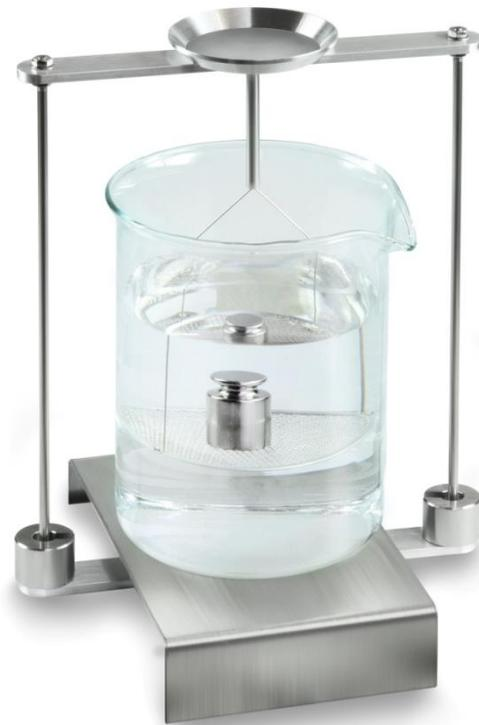
Abb.2: Wägung in Hilfsflüssigkeit
