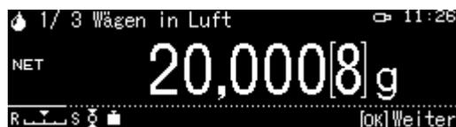
Das Gewicht des Senkkörpers in Luft wird angezeigt.
