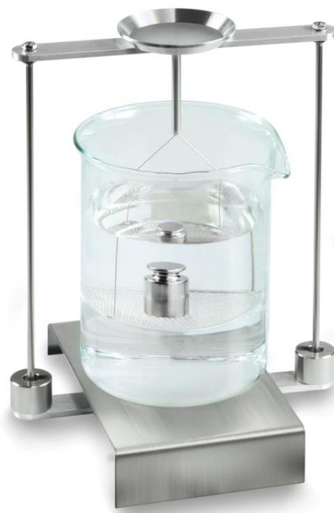
Abb.2: Wägung in Prüfflüssigkeit
