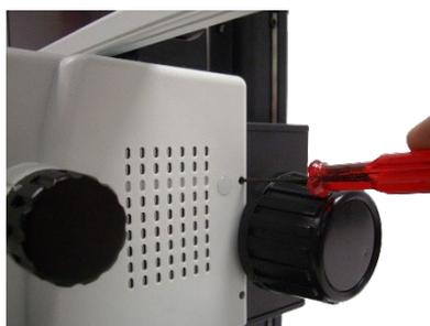
Um den Mikroskopkopf am Ständer zu befestigen, ziehen Sie die Schrauben (2x) an der Außenseite des Gehäuses mit dem mitgelieferten Inbusschlüssel fest.
